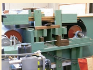
粘土のかたまりを棒状に成形する機械。社長と社員による手作りのため、外枠は木製。見栄えはよくないが現役としてしっかり動いている
