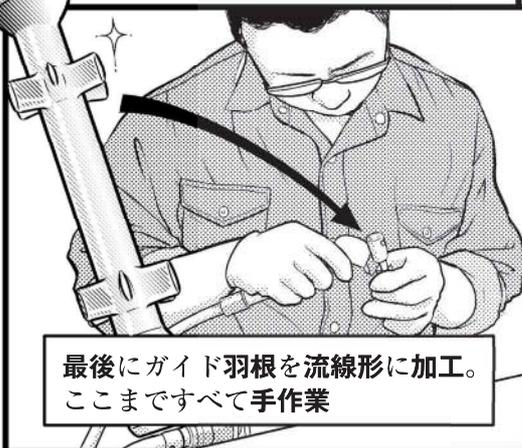
最後にガイド羽根を流線形に加工。
