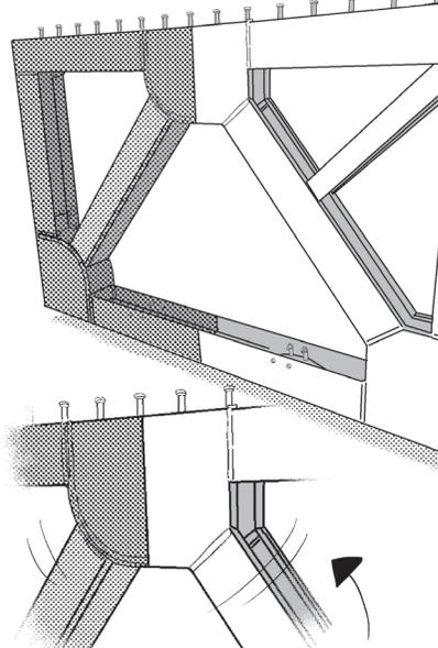
耐震鉄骨構造の改修工事は実際の図面上と寸法が異なることがあります。弊社の耐震ブレースを使用することで、実測せずにある程度先行して製作が可能です。
